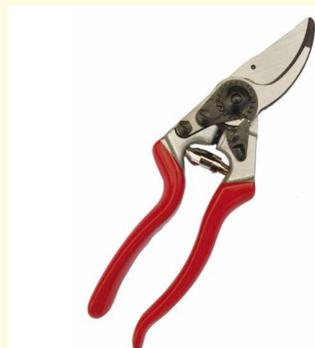
Die **Baumschere** ist das wichtigste Werkzeug. Bei guten Scheren ist die Schneideklinge austauschbar, damit sie geschärft werden kann. Wichtig ist, dass sich der Anpressdruck der Klinge exakt einstellen lässt, sodass die Schere gerade noch von selber auseinandergeht. Ein ergonomischer Griff verhindert Gelenkschmerzen.
