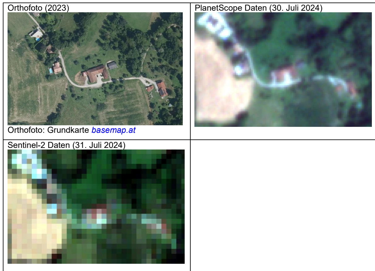
Abbildung 13: Echtfarbandarstellungen desselben Ausschnittes zur Visualisierung der unterschiedlichen Bildauflösungen der einzelnen Sensoren: Orthofoto mit 20 cm, PlanetScope mit 3 m und Sentinel-2 mit 10 m.
