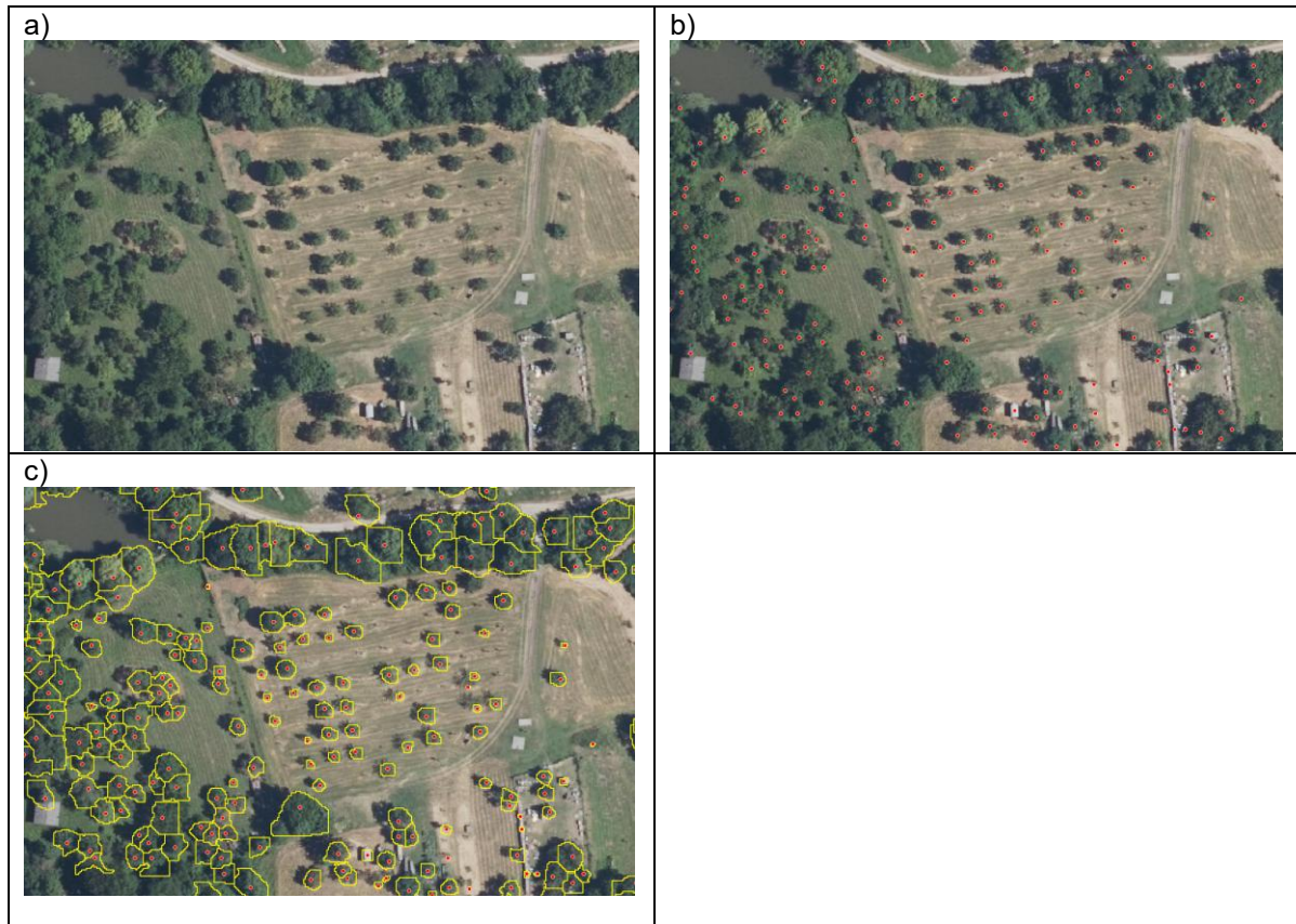
Abbildung 17: Detektion und Abgrenzung der Baumkronen: a) Orthofoto; b) Orthofoto mit Baumspitzen = rote Punkte = lokale Maxima und c) angenäherte Baumkronen (gelbe Polygone) Orthofoto Grundkarte: basemap.at
