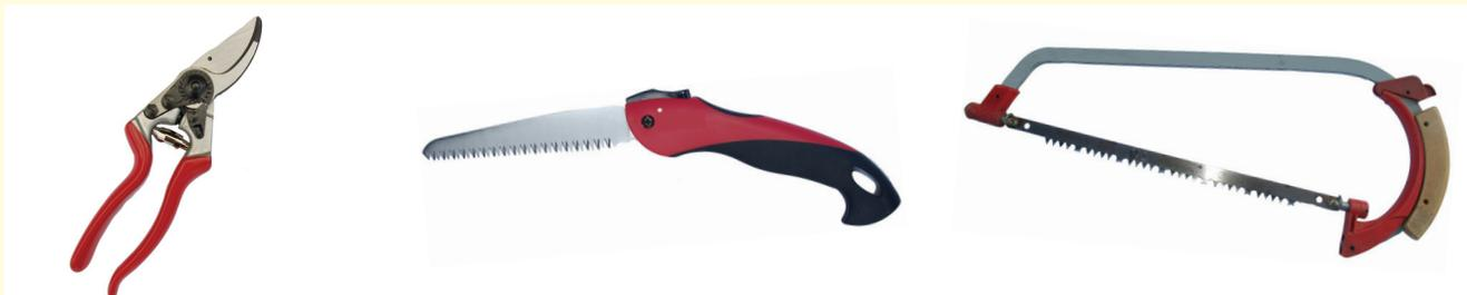
Die **Baumschere** ist das wichtigste Werkzeug. Bei guten Scheren ist die Schneideklinge auswechselbar, damit sie geschärft werden kann. Wichtig ist, dass sich der Anpressdruck der Klinge exakt einstellen lässt, sodass die Schere gerade noch von selber auseinandergeht. Ein ergonomischer Griff verhindert Gelenkschmerzen.
